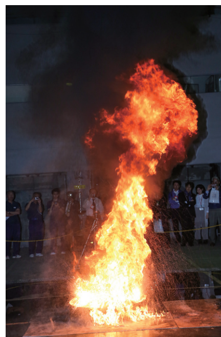
写真3 ボイルオーバー現象 （高温となった軽油が水に接触して飛び散る様子）
